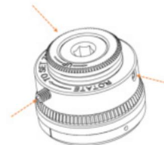
5. Затяните 3 фиксирующих винта на внешней крышке барабана ввода поправок.
