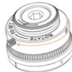
3. После установки «нулевой» отметки затяните фиксирующие винты на кольце. Если фиксирующие винты перетянуты, кольцо может исказиться (потерять круглую форму). Это может помешать нормальному вращению.
